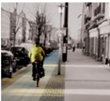
Une **piste cyclable** est séparée de la chaussée par une bordure de trottoir et du trottoir par un marquage, pavage ou un bord bas de trottoir.
