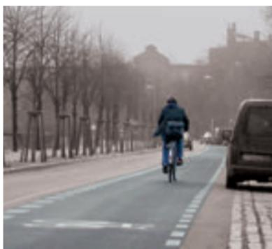
La **bande de protection** est signalée sur la route par une ligne non passée et un pictogramme avec un vélo. Des véhicules à moteur sont seulement permis de l'utiliser s'ils doivent éviter la circulation en sens inverse.
